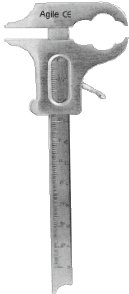
AGi-05-100 Boley Measuring Range Boley Діапазон виміру 0-100mm, 14 cm
